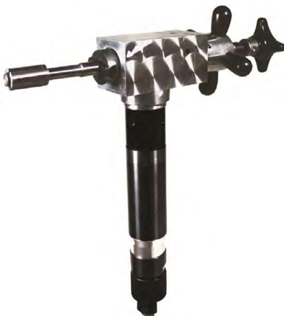
Обычно ремонт теплообменника является менее затратным по сравнению с приобретением нового. При наличии подходящего инструмента ремонт легко производится как в условиях завода, так и на монтаже. У компании DWT есть отличное решение для удаления поврежденных труб с большой толщиной стенки из трубной доски. Машина MF3iw со специальной фрезой легко срезает сварной шов для удаления старой трубы из теплообменника, одновременно подготавливая при этом фаску для приварки новой.
