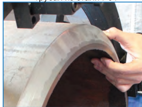
Резка и торцовка на большой толщине
