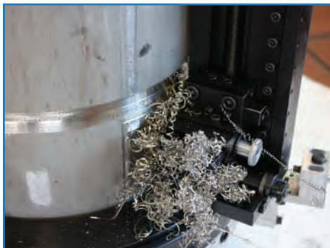
Продольное снятие сварного шва
